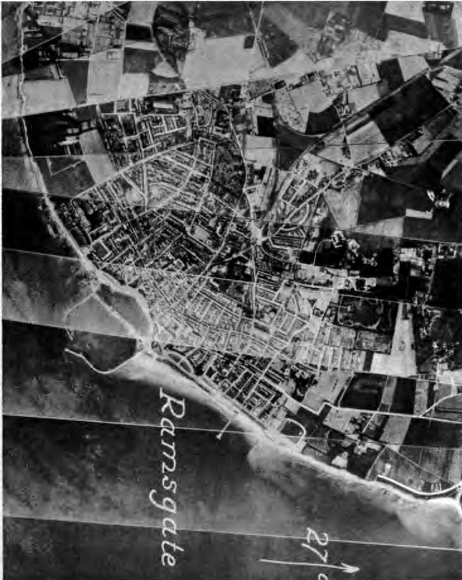
Abb. 133. Teil eines Reihenbildfluges über England. 6000 m Höhe; 25 cm Brennweite. Küstenstadt Ramsgate mit Hafen, darin einzelne Schiffe. Die Streifen sind die aufeinanderfolgenden Aufnahmen, die zusammengesetzt und einheitlich kopiert werden.
