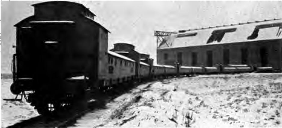
Abb. 45. In einen Eisenbahnzug zusammengestellte Gaskesselwagen (Frank-Bremen). Gesamt-
