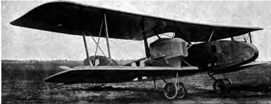
Abb. 73. Albatros G III (s. Tab. III, Nr. 42). Rechts und links vom Rumpf je ein Stahlrohrstielpaar. Strahlkühler. Oben und unten geteilte Flügel. 3 Sitze hintereinander; Führer inmitten.
