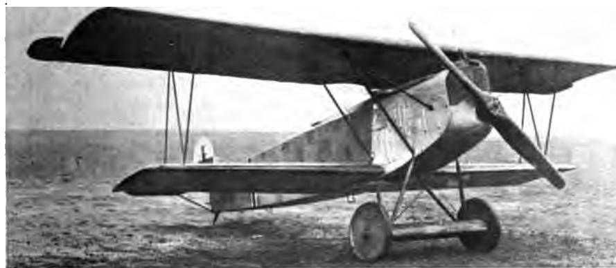
Abb. 69. Fokker D VII (s. Tab. II, Nr. 29). Verspannungsloser Einstieler. Stützflügel.
