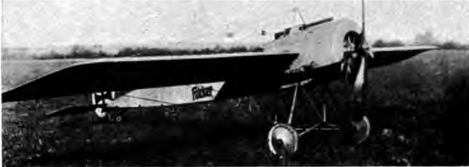
Abb. 65. Fokker E I/1915 (s. Tab. II, Nr. 38). Das erste deutsche Jagdflugzeug mit auf dem Silbe gut erkennbarem, im Spannturm liegendem, motorgesteuertem, stark eingebautem M. G. Zahlreiche obere und untere Verspannungsdrähte (vgl. Abb. 71/72 und 64). Umlaufmotor. Das erste Flugzeug Voeldes für den Luftkampf.
