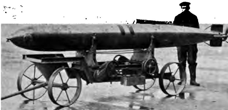
Abb. 194. Flugzeugtorpedo auf Torpedoladewagen.
