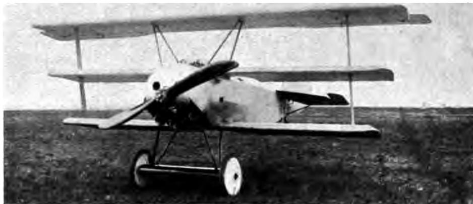
Abb. 70. Fokker Dr I (s. Tab. II, Nr. 37). Gleichfalls verspannungslos. Umlaufmotor. M. G. ragen über die Haube.
