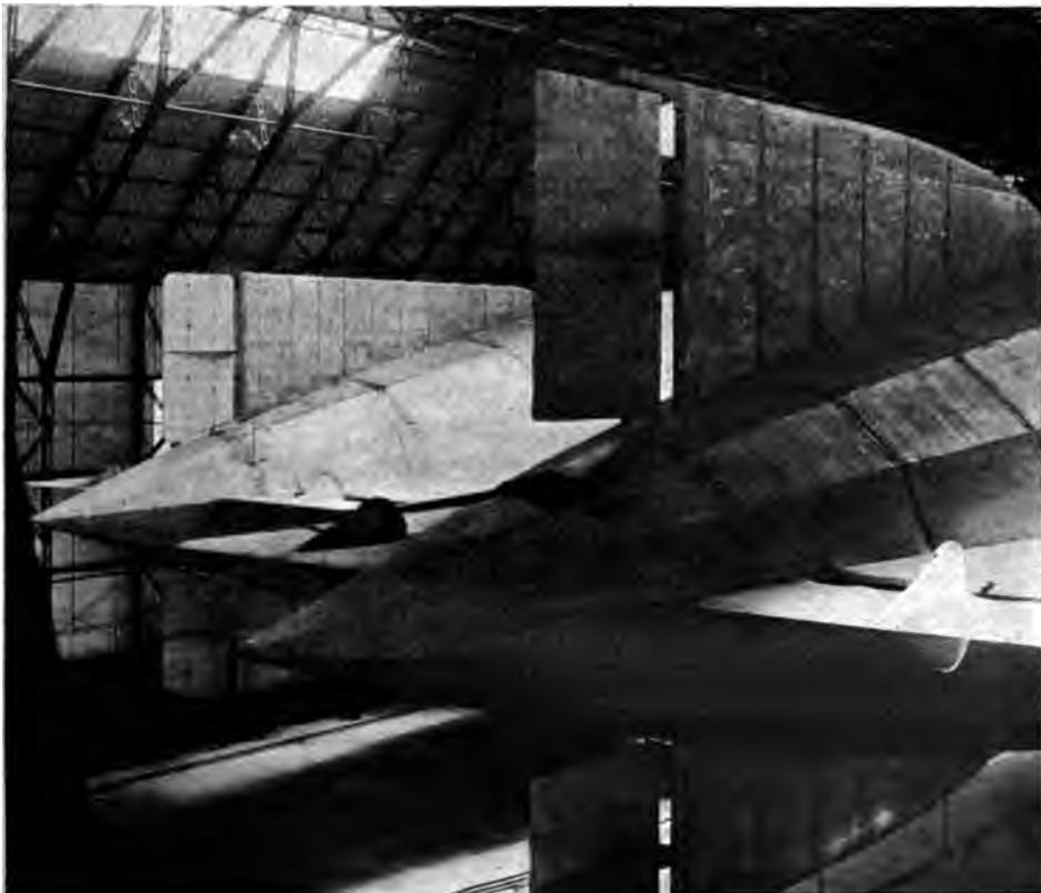
Abb. 21. Bild auf das Hinterschiff zweier Zeppelinluftschiffe mit wagerechten und senkrechten Dämpfungsflächen, Höhen- und Seitensteuern.
