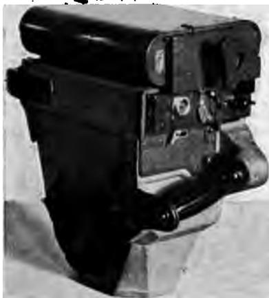
Abb. 135. Rollfilmkamera. Auf die normale Kammer  $13 \times 18$  mit 25 cm Brennweite ist eine Rollfilmkassette angepaßt. Durch Drehung des dreieckigen Knopfes wird der Film transportiert und gleichzeitig der Verschluss gespannt.
