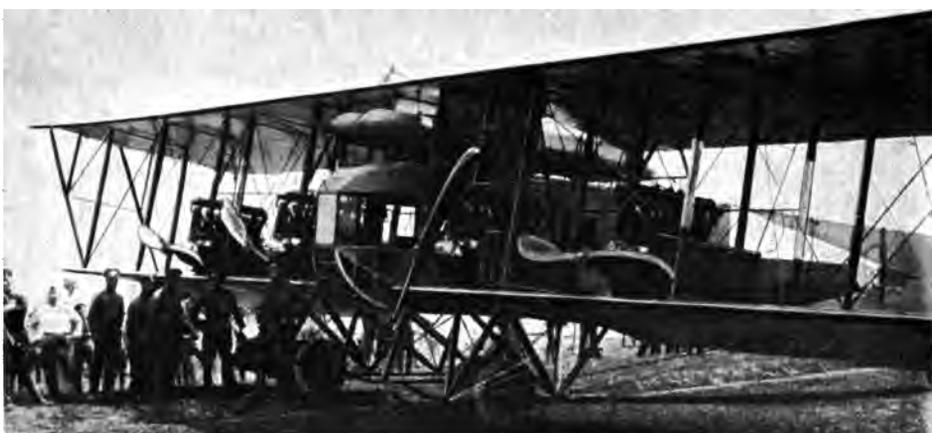
Abb. 80. Dasselbe in Vorderansicht. Vorderer Rumpfteil als geschlossene Kabine gebaut. Auf Tragflächen 4 Motoren mit Zugschrauben. Über der Kabine Benzintank. Flog mit 7 Mann Besatzung.
