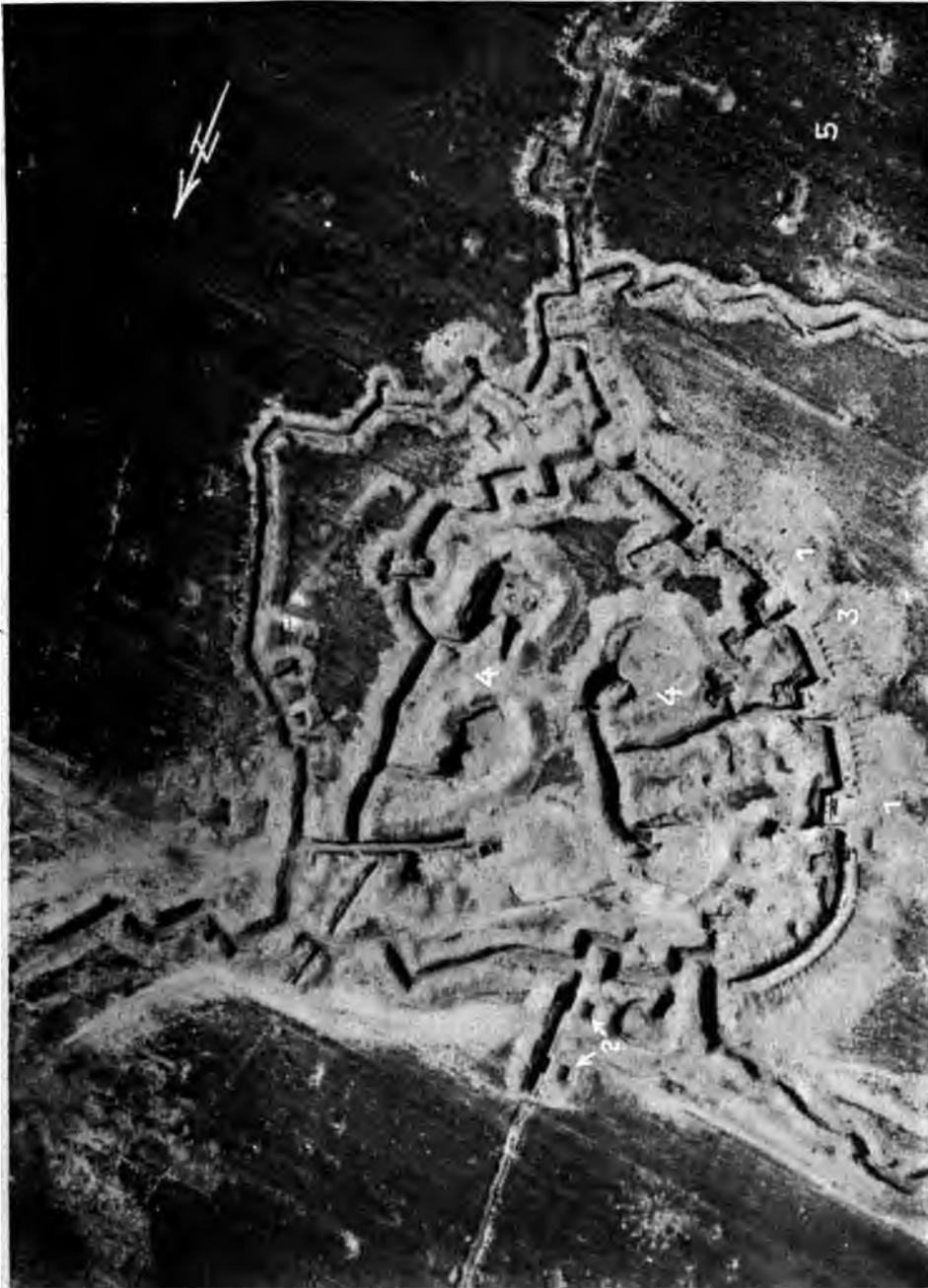
Abb. 137. Beispiel für Zielertundung mit 120 cm Brennweite. Das feindliche Erdwert in allen Einzelheiten erkennbar: Bei 1 M. G.-Stand, erkennbar am Auschußfeld; 2 Minenwerferstand, niedrige Auschußöffnung; 3 Schießscharten; 4 Unterstände; 5 Pfähle des Drahthindernisses.
