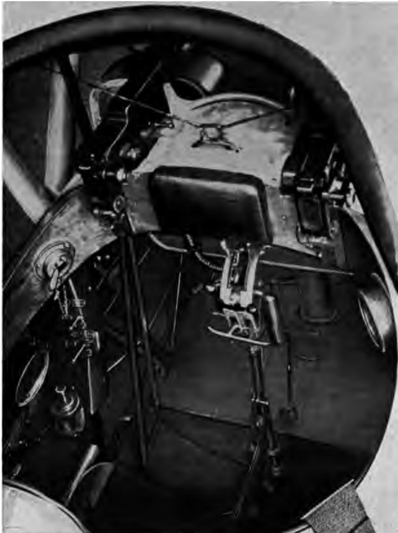
Abb. 191. Steuerfäule, Abzugsvorrichtung und Verschlussstück der beiden starren M. G. beim Siemens-Schudert D IV.
