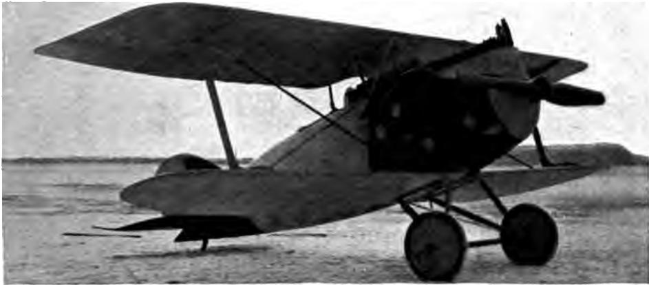
Abb. 67. Rumpler D I (s. Tab. II, Nr. 33). Einstieler mit eigenartiger Verspannung. Kurzer, hoher Rumpf. Rechtes Motor-M. G. erkennbar.
