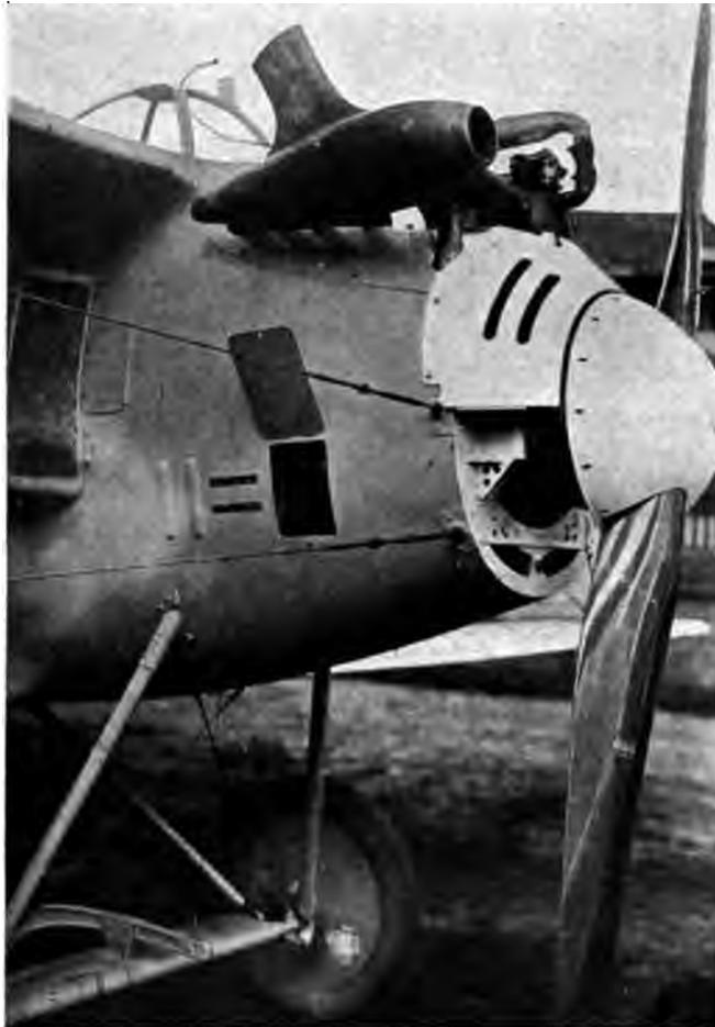
Abb. 55. Rumpfvorderteil des LFG C II mit Motoreinbau, Auspufftopf (tropfenförmig), Propellerhaube, Ohrentüblern, Spannriemen. Achse mit Verkleidung in tropfenförmigem Querschnitt.
