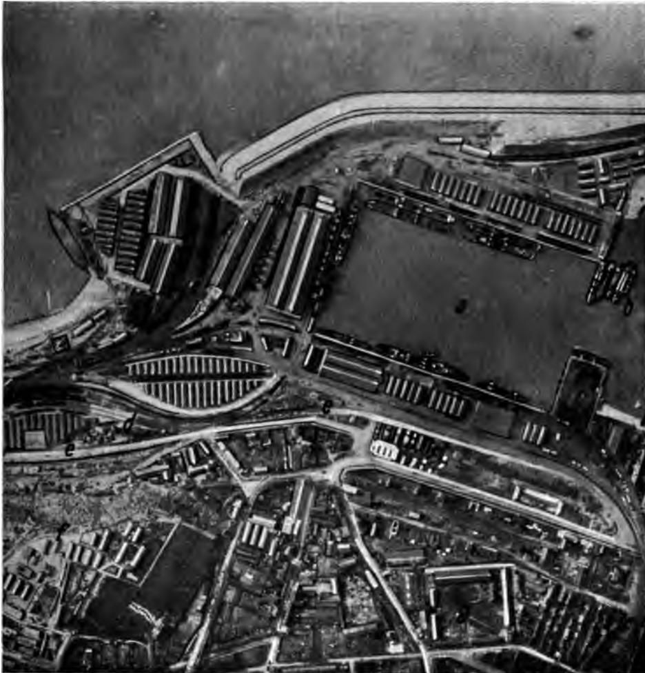
Abb. 144. Boulogne sur Mer, Bassin Loubet (April 1916). Bei a 5 groe und 3 mittlere Frachtdampfer, bei b 3 Bagger. Hafenbassin umsumt von groen Gterhallen und Schuppen; zwischen ihnen Gleise. Gterstapel bei e. Auf sudlichem Quai mit Lupe die eisernen Gittertrger der Ladetrane erkennbar. c Wasserflugstation, d Wasserturm, f Anfang des groen Barackenlagers von Capecture, g Arsenal.
