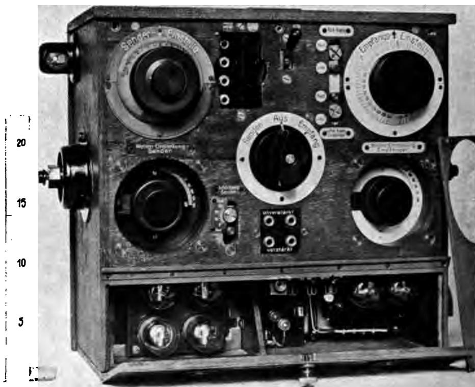
Abb. 165. Ungedämpfter Sender-Empfänger, Type USE I (Telefunken).
