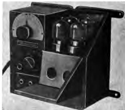
Abb. 159. Telefunken-Audion-Empfänger mit eingebautem 3 Röhren-Verstärker.
