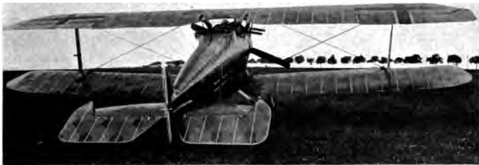
Abb. 63. Hannover CL V (s. Tab. I, Nr. 11). Einzieler mit einer Verspannungsebene. Sehr hochgezogener Fournierhautrumpf. Sitz und Schußfeld über oberes Tragged.
