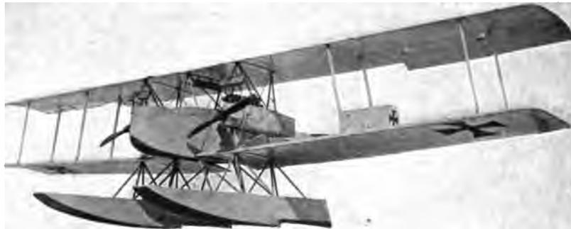
Abb. 106. Hanja-Brandenburg G-Flugzeug mit zwei 160 P. S.-Mercedesmotoren.
