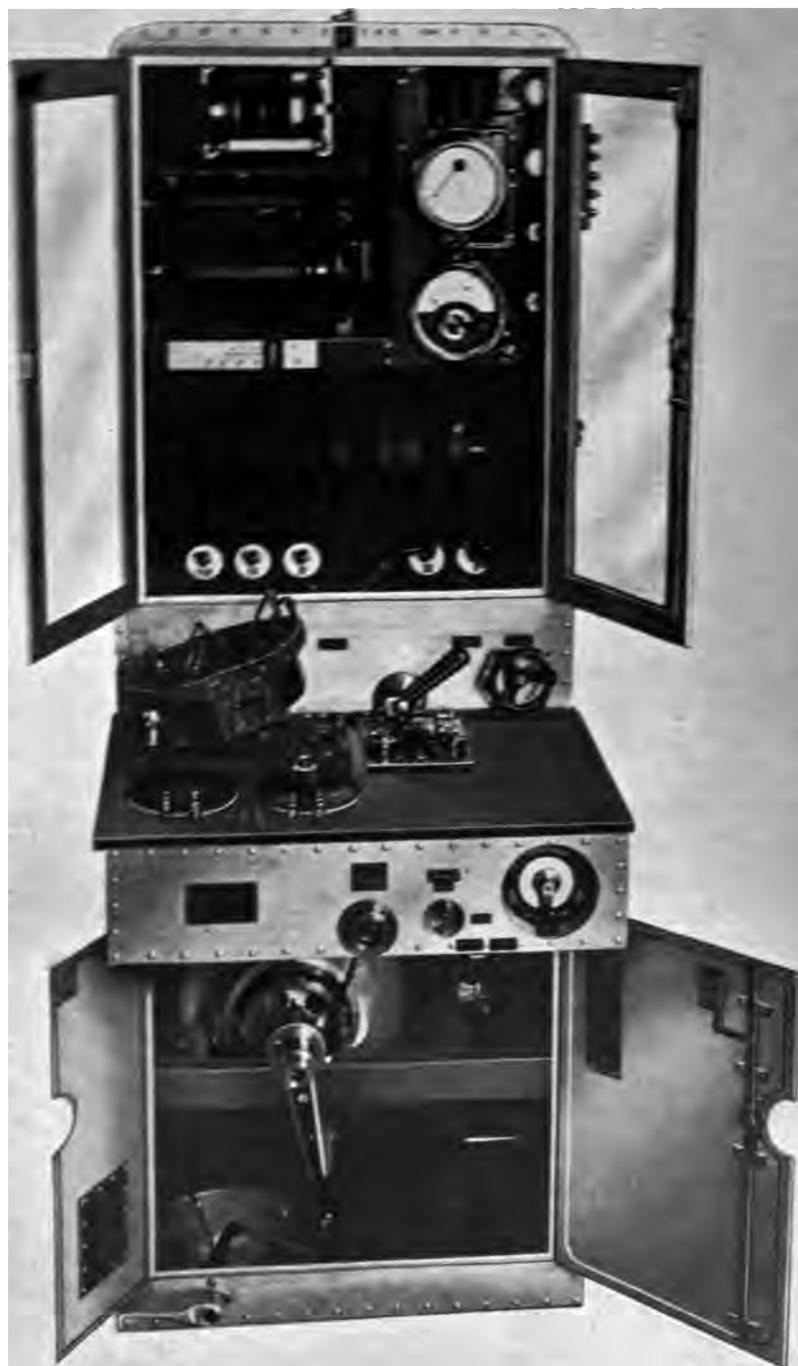
2166. 147. Luftschiff-F. L.-Station älterer Bauart (Telefunken).
