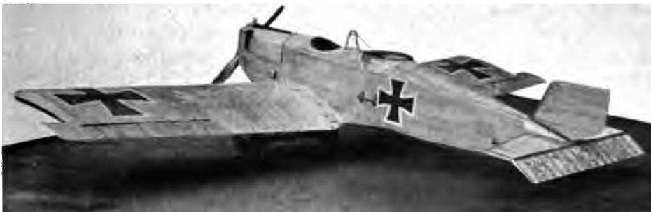
Abb. 64. Junters-Fokker CL I (s. Tab. I, Nr. 12). Ganzmetallflugzeug, sogen. Tiefdecker mit hervorragend freiem Gesichts- und Schußfeld. Verspannungslos.
