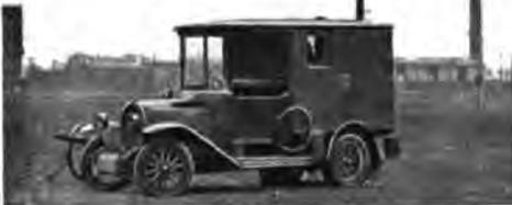
Abb. 156. Flieger-Hasenstation, betriebsbereit aufgebaut (Telefunken).
