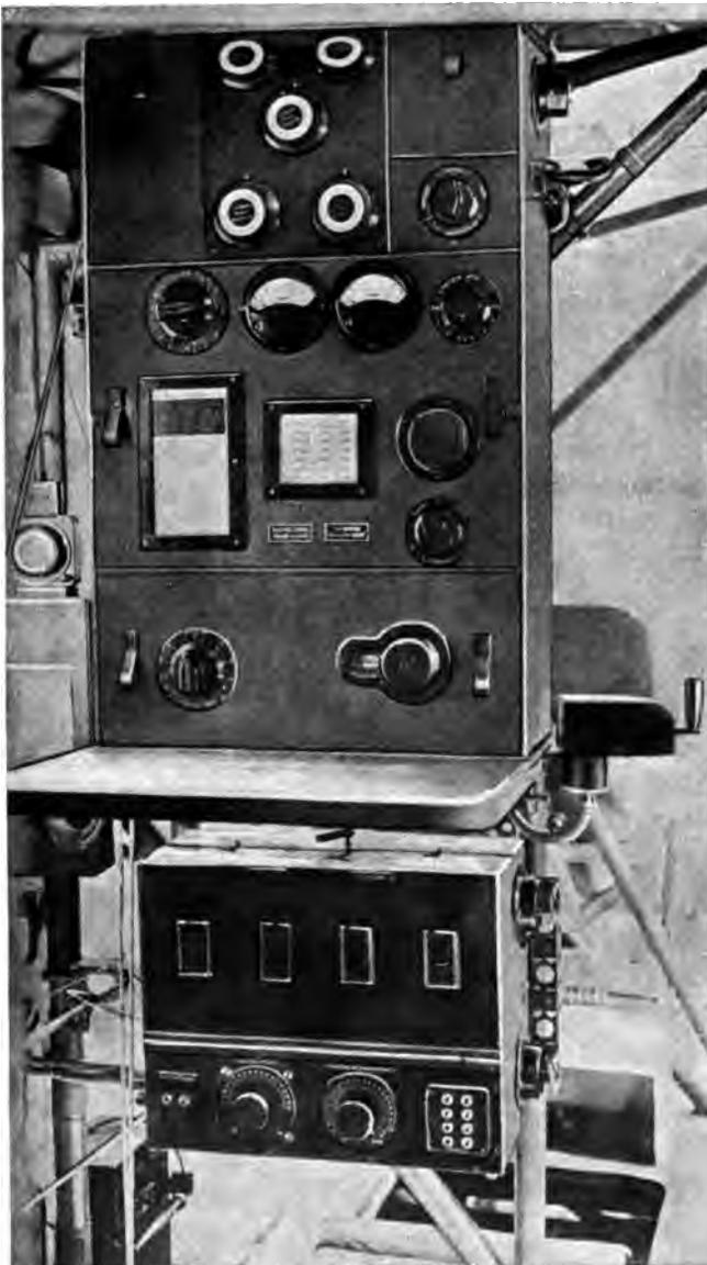
Abb. 161. Sender-Empfänger im Riesenflugzeug. (Telefunken, neuere Ausführung.)
