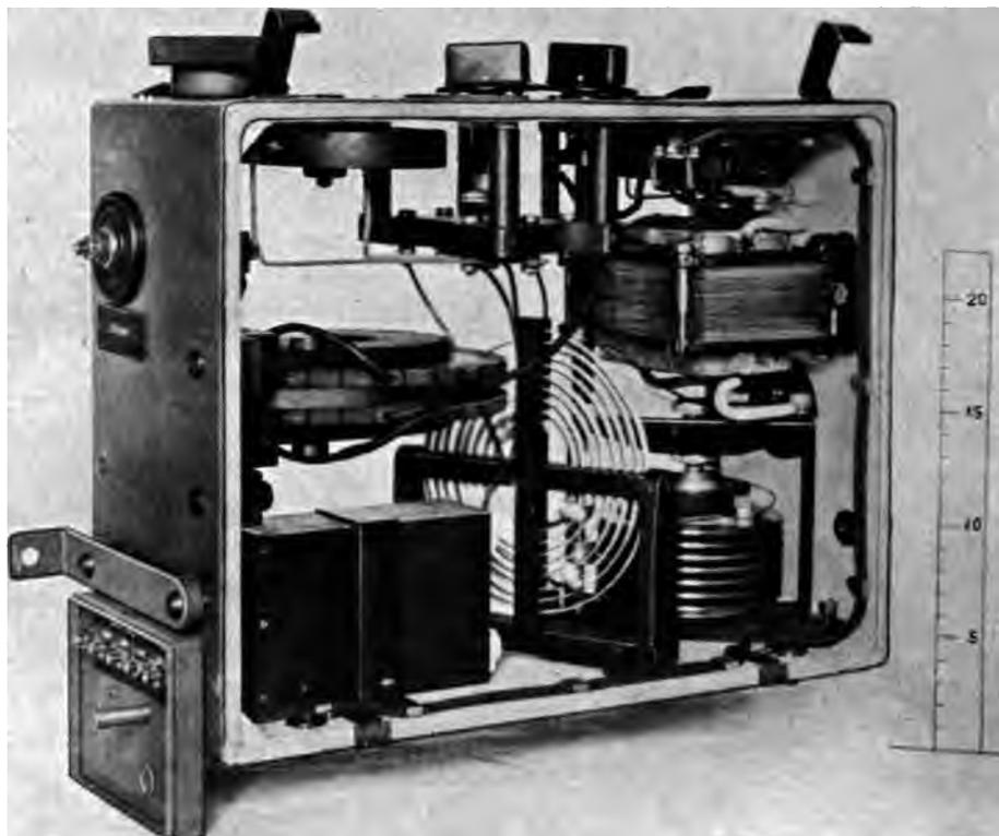
Abb. 150. Kleiner Flugzeugsender für C-Flugzeuge, Wellen 150, 200, 250 m (Telefunken).
