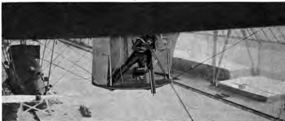
Abb. 184. M. G. senkrecht nach unten feuernd bei der hinteren Gondel. Der Stand ist zum Einturbeln ins Schiff eingerichtet.
