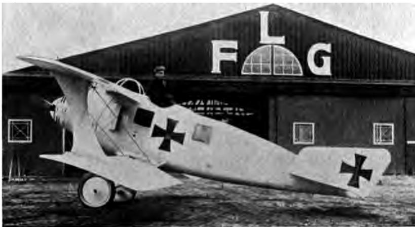
Abb. 54. LFG C II (s. Tab. I, Nr. 13), genannt „Walffisch“ (1915/16) 1. Flugzeug mit tropfenförmigem Rumpf in Stromlinienform. Luftwiderstand auf geringstes Maß beschränkt. Eng anliegende Ohrentübler, Flächenstiel: höhere Festigkeit, geringeres Gewicht, günstiger Luftabfluß. — Tragdeckabstand gleich Rumpfhöhe: freies Sicht- und Schußfeld über oberes Tragdeck. Gewidelte Rumpfhaut. Im Rumpf Fenster.
