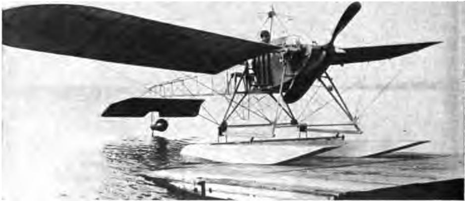
Abb. 93. Eines der ersten deutschen Seeflugzeuge. Typ: Flugzeugbau Friedrichshafen mit Orlikon-Motor.
