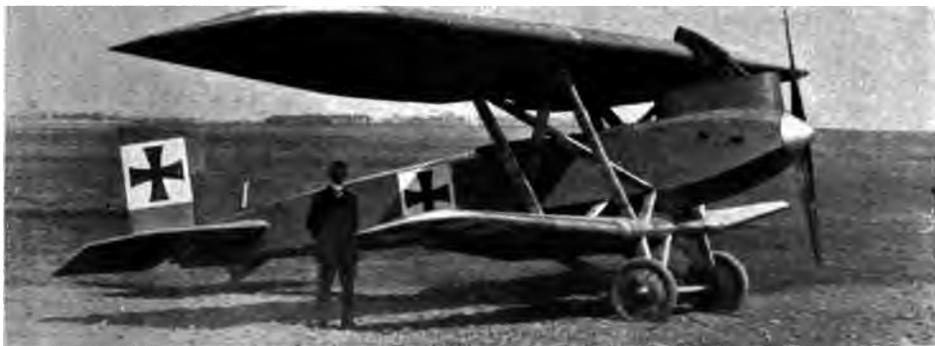
Abb. 60. Junkers-Fotter J I (s. Tab. I, Nr. 23). Verspannungsloses Ganzmetallflugzeug. Motor im Panzerschutz einbegriffen. Ungewohnt dickes Tragdeckprofil erkennbar.
