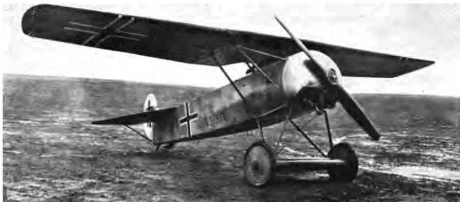
Abb. 71. Fokker D VIII (s. Tab. II, Nr. 30). Verspannungsloser Hochdecker mit Umlaufmotor. Benzintank abseits des Rumpfes in Höhe der Achse zwischen den Rädern, um beim Luftkampf die Brandgefahr zu verringern.
