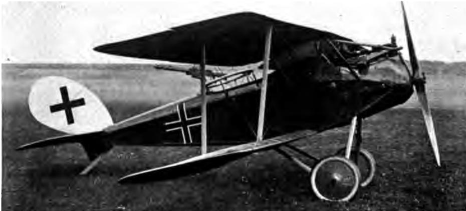
Abb. 62. Halberstadt CL IV (s. Tab. I, Nr. 8). Einzieler mit 2 Verspannungsebenen. M. G. im Beobachteritz besonders deutlich, ebenso die gedrungene, kurze und leichte Bauart dieses Schlachtflugzeuges.
