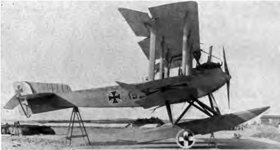
Abb. 96. Seefähiges Friedrichshafener Aufklärungsflugzeug mit 200 P.S.-Benzmotor.
